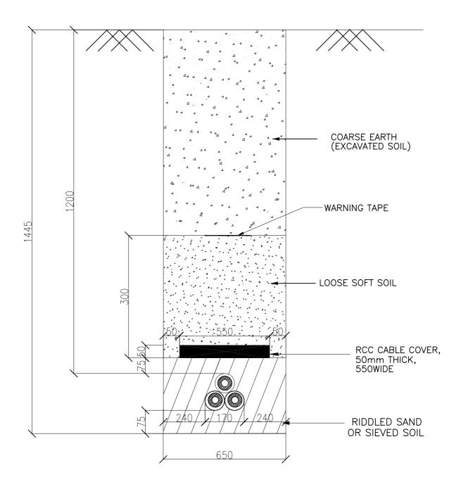
TYPICAL DETAILS FOR 66KV BURRIED CABLE FOR SINGLE CIRCUIT TYPE - B 4
