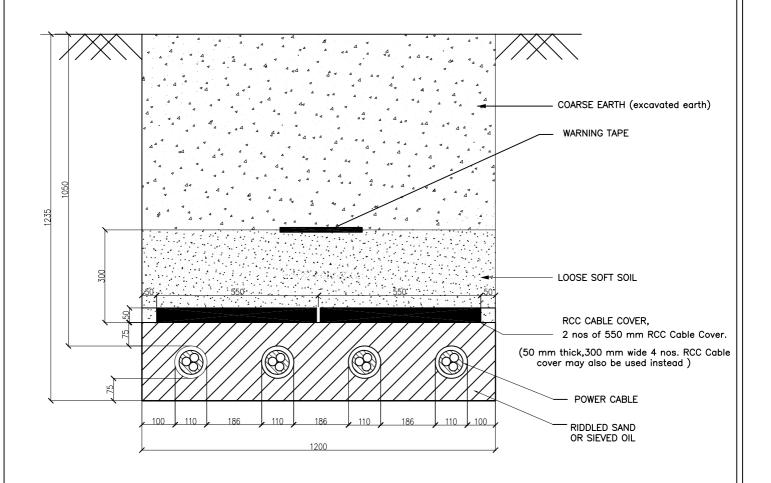
TYPICAL DETAILS FOR 33KV BURRIED CABLE FOR FOUR CIRCUIT  $\mathsf{TYPE} \, - \, \mathsf{C} \, \, \mathsf{1}$
