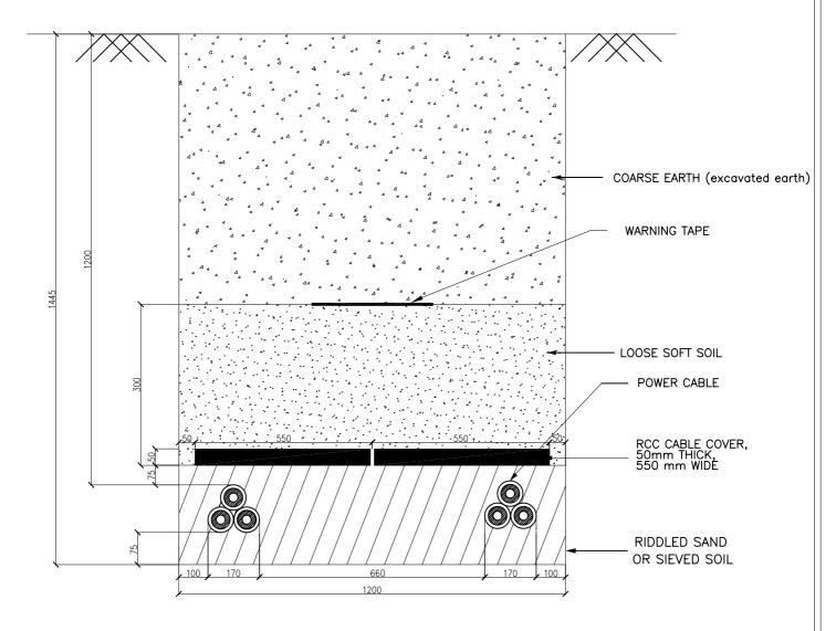
TYPICAL DETAILS FOR 66KV BURRIED CABLE FOR TWO CIRCUIT TYPE - C 2
