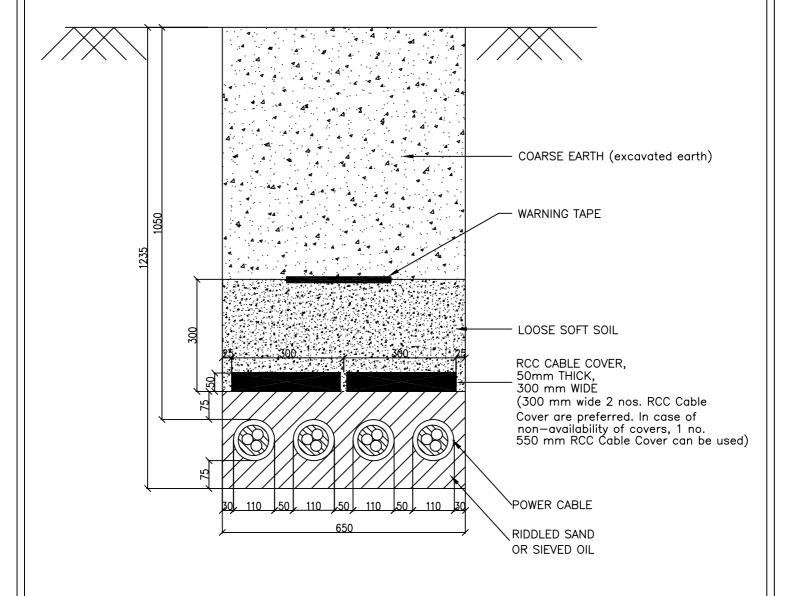
TYPICAL DETAILS FOR 33KV BURRIED CABLE FOR FOUR CIRCUIT
